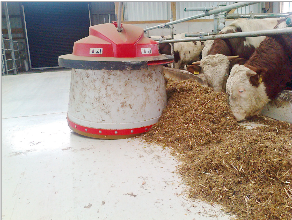
Abb. 17: Futteranschiebe-Roboter schieben die Ration nach einmalig festgelegten Routen mit jeder weiteren Fahrt näher zu den Tieren.
