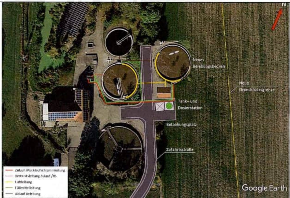
Lageplanskizze der Umbaumaßnahme in der Kläranlage Goldkronach
