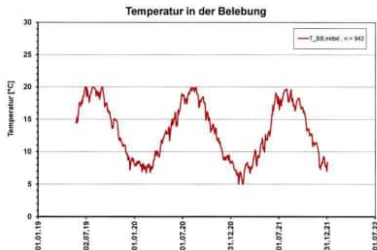
Abbildung 2.15: Verlauf der Temperaturen im Belebungsbecken
