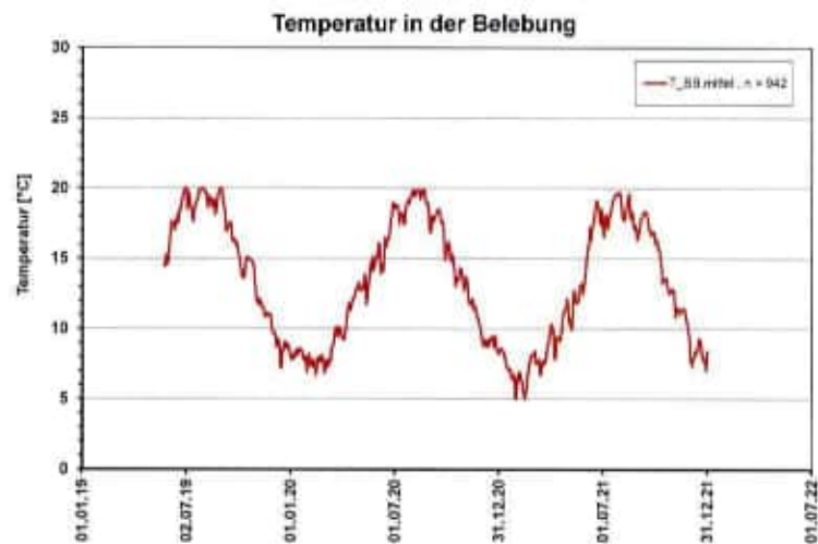
Abbildung 7.3: Verlauf der Temperaturen im Belebungsbecken
