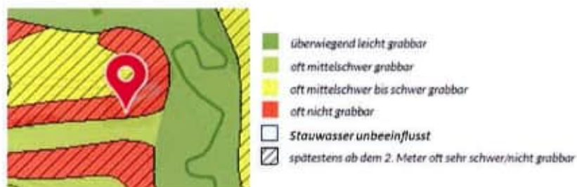
Abbildung 7: Wassereinfluss und Grabbarkeit im Bereich der Kläranlage Hollfeld [1]
